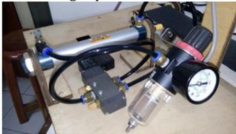
Gambar 4.4 Pengujian Katup Kontrol Arah
