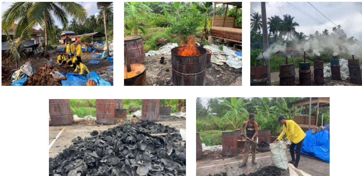
Gambar 1. Proses pengolahan limbah batok kelapa menjadi arang
